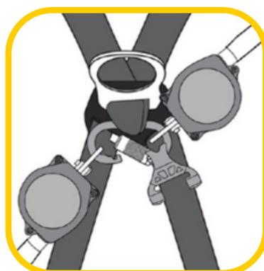
Com o conector posicionado como na imagem, faça a abertura e insira o segundo mini trava queda retrátil e faça o fechamento do conector
