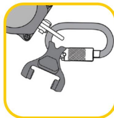
Insira um dos mini trava queda retrátil no conector metálico e prepare para inserir no espaço criado anteriormente nas fitas próximas a ancoragem dorsal
