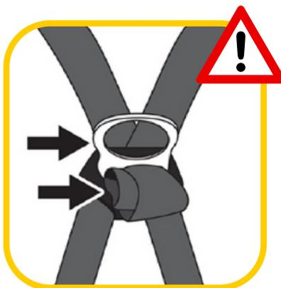
**ETAPA CRÍTICA, ATENÇÃO:** Prepare a fita do cinturão de segurança afrouxando as duas fitas junto ao anel de ancoragem dorsal, criando um espaço para a passagem do conector metálico.\*
