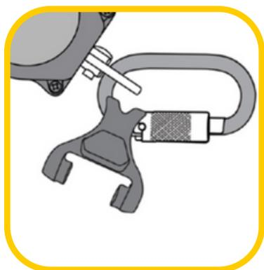
Destroce o plástico separador do mosquetão e faça a retirada de um mini trava queda retrátil.
