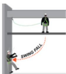
Quedas em pêndulo podem ser perigosas pelo choque contra estruturas no trajeto, e principalmente por requererem maior zona livre de queda pois o equipamento poderá não travar tão rapidamente em caso de queda em pêndulo.
