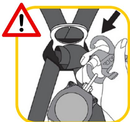
**ATENÇÃO:** Insira o conector metálico na passagem, com 1 (um) dos mini trava queda já instalado, apontando o nariz do mosquetão como está na imagem, passando-o da direita para a esquerda.\*\*
