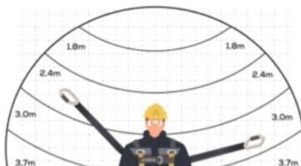
Caso não seja possível ancorar-se acima da cabeça, o mini trava-queda retrátil pode ser ancorado em qualquer região da imagem ao lado.
