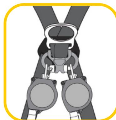
Posicione o separador do mosquetão na posição fechada e travado, efetivamente distanciando os dois mini trava queda e faça o ajuste das fitas para que assegurem o conector metálico contra o espaldar plástico do cinturão de segurança firmemente.
